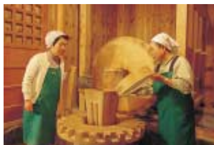
水車で粉を2度びきしています
